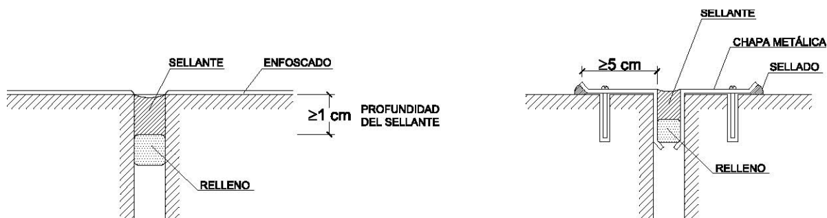
Figura 2.6 Ejemplos de juntas de dilatación
